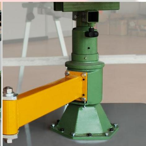
Permite que la máquina realice una rotación de 360°, lo que permite realizar múltiples acciones de mecanizado desde el recorte circular.
