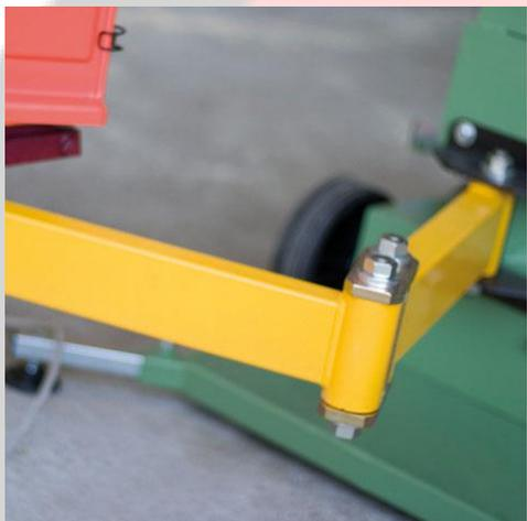
El brazo articulado es el instrumento que caracteriza a todas las máquinas MD DARIO. Consiste en un conjunto de juntas que permiten que la sierra gire fácil y en cualquier dirección.
