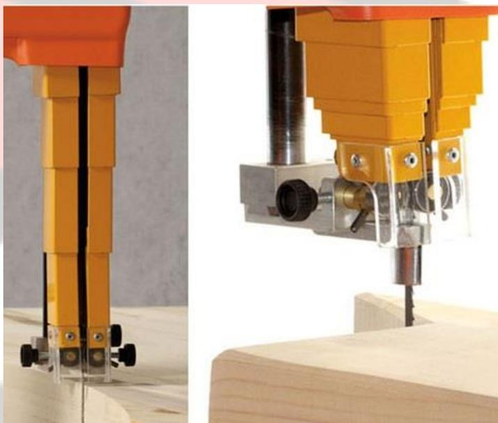
El sistema de fuelles es un sistema telescópico de protección de la hoja, que se puede ajustar en función de la altura de corte que se va a realizar, garantizando así, la seguridad en la etapa del corte.
